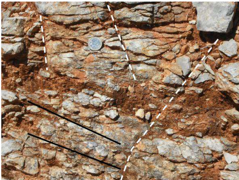
Figura 7.1. Alteração do calcário da Formação de Escarpão. As fraturas representadas com linhas brancas tracejadas e os planos de camada representados com linhas pretas contínuas, facilitam a penetração da água. Note que os planos de camada estão quase completamente obliterados devido à alteração. Desta, resultam fragmentos de calcário e argila de cor vermelha (terra rossa). Na alteração deste afloramento, concorreram ambas as formas de meteorização: química (dissolução) e física (fraturação).
